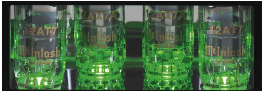
QUARTETT OHNE SILIZIUM: Wahlweise übernehmen Röhren die Ausgangsstufe. Pro Kanal arbeiten jeweils eine Doppeltriode vom Typ 12AT7 (ECC81) und 12AX7A (ECC83).
